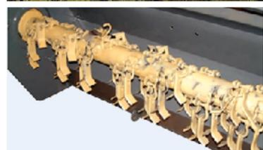
L'épareuse à fléaux a été pensée pour débroussailler les accotements tandis que l'épareuse à marteaux est généralement assez puissante pour broyer des tiges ligneuses.
